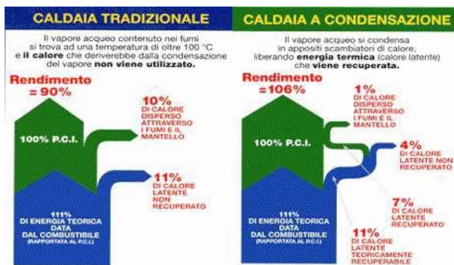
Fig.9 Vantaggi caldaia a condensazione
